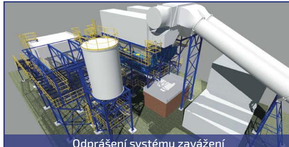
Odprášení systému zavážení
